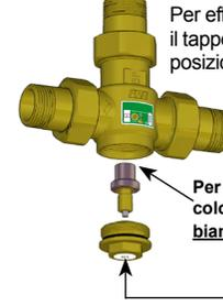
Per effettuare la modifica è sufficiente svitare il tappo, rimuovere manualmente il sensore e posizionare quello scelto in sostituzione.
